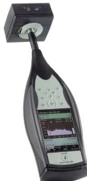
2. ábra a 4231 kalibrátor a 2250 hang analízátorra helyezve A kalibrátor tömegközéppontja közel esik a behelyezett mikrofonhoz, így stabil
